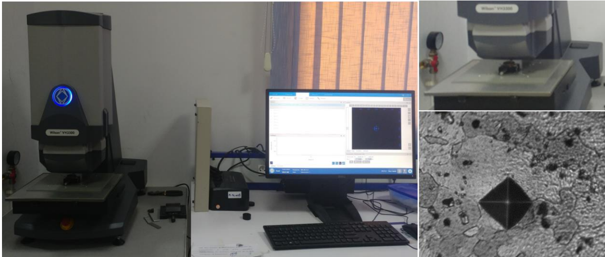
Figure II.12 Microduromètre Wilson VH3300 - Microdureté Vickers
