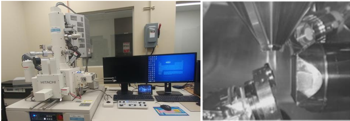
Figure II.19 Microscope électronique à balayage HITACHI SU8230 et une vue de l'intérieur de la chambre du microscope électronique
