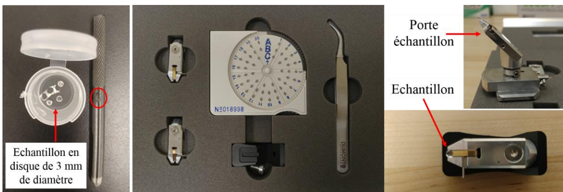
Figure II.21 Mise de l'échantillon sur le porte échantillon de TKD
