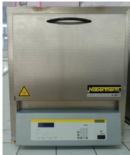
Figure II.10 Four à chambre de marque Nabertherm - traitement thermique isotherme
