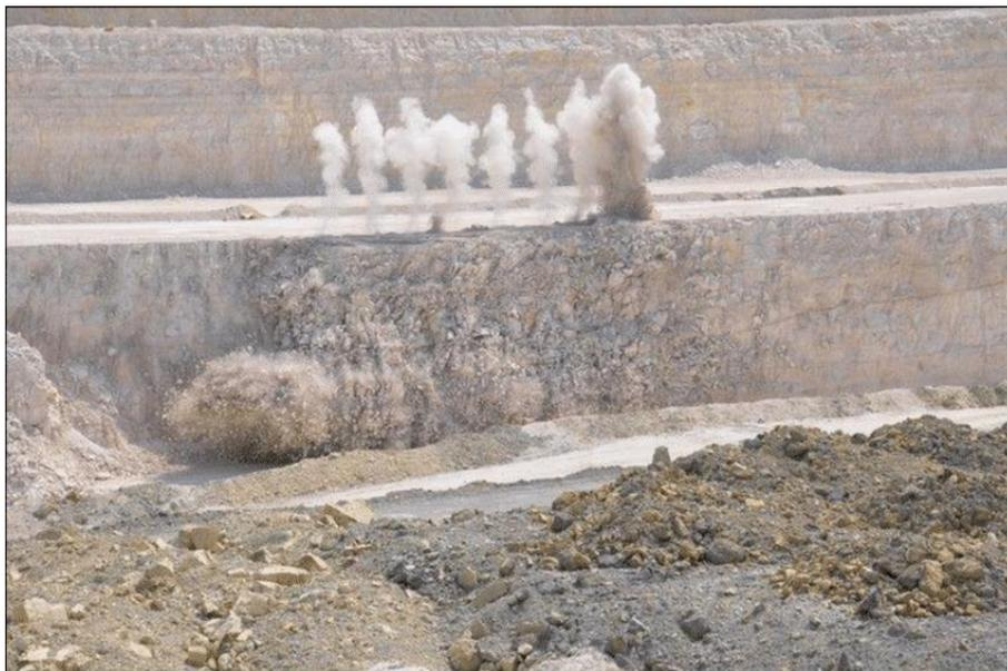
Figure I. 3. Exploitation par explosif
