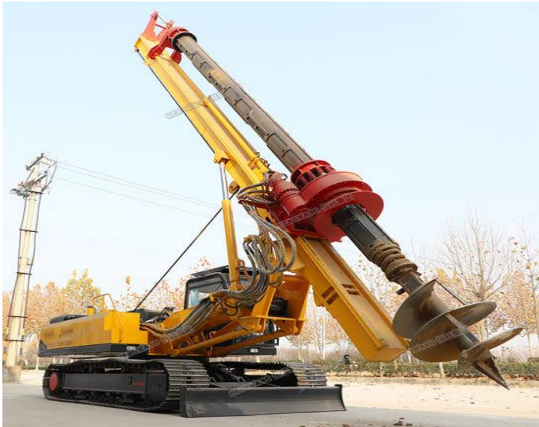
Fig.I.1,Appareil de forage rotatif. [1]
