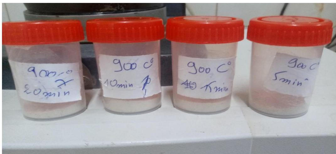
Fig. III. 5,représente 4 échantillons calciné à 900C° dans diverses durées de 5 à 20 minute
