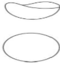
FIGURE I.38 – Géométrie d'une pointe d'indentation sphérique et de l'empreinte résiduelle due à ce type
