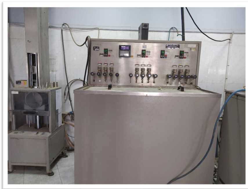
Figure III.3 Machine test de la pression hydrostatique (éclatement).
