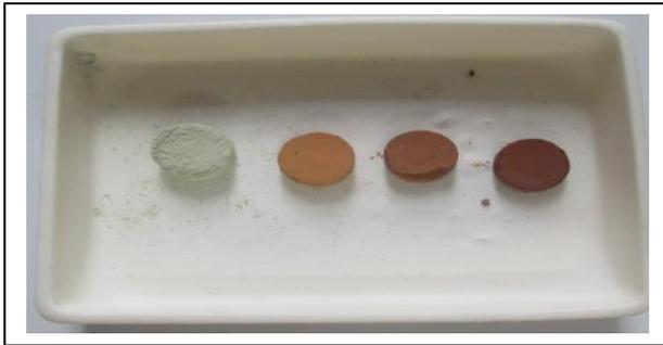
Figure (III.2) échantillon avant frittage.
