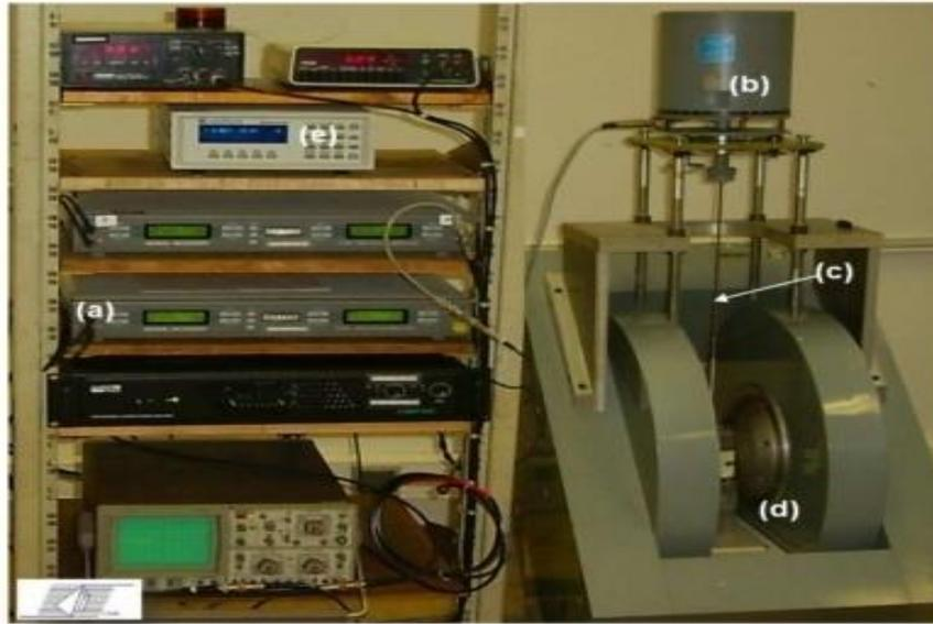
Figure (II.3) Image du magnétomètre utilisé.[4]
