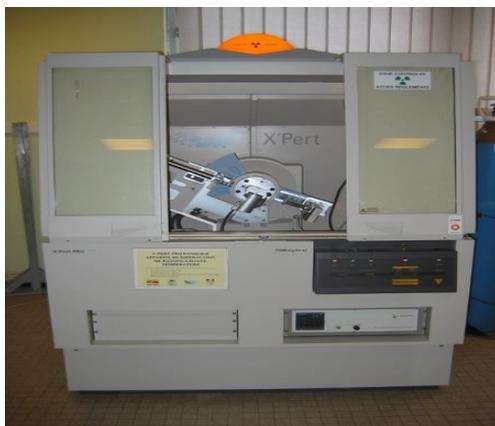
**Figure III.15** Présentation de diffractomètre utilisé.
