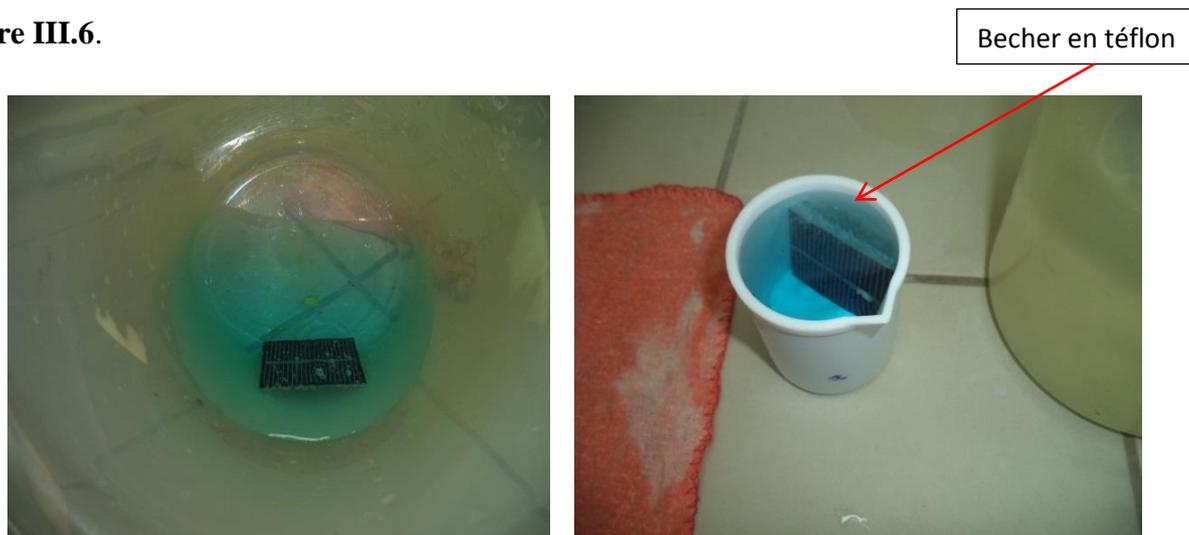
**Figure III.6** Présentation de dépôt électroless du cuivre.
