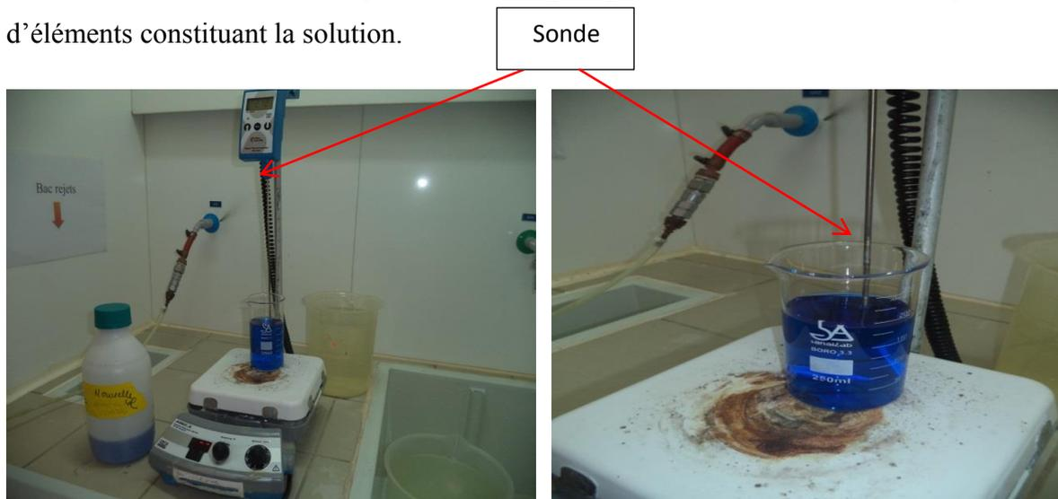
Figure III.4 Présentation de dépôt électroless de Nickel.
