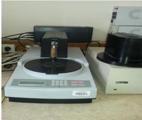
**Figure III.9** Appareil pour les mesures de la résistance carrée.
