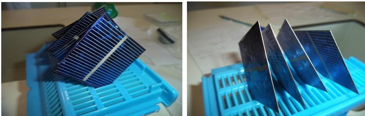
**Figure III.1** Plaquettes après l'élimination des oxydes par l'HF.
