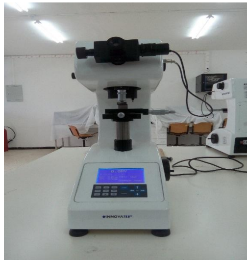
Figure II. 18: Schéma de la machine de micro dureté (INNOVA Test)
