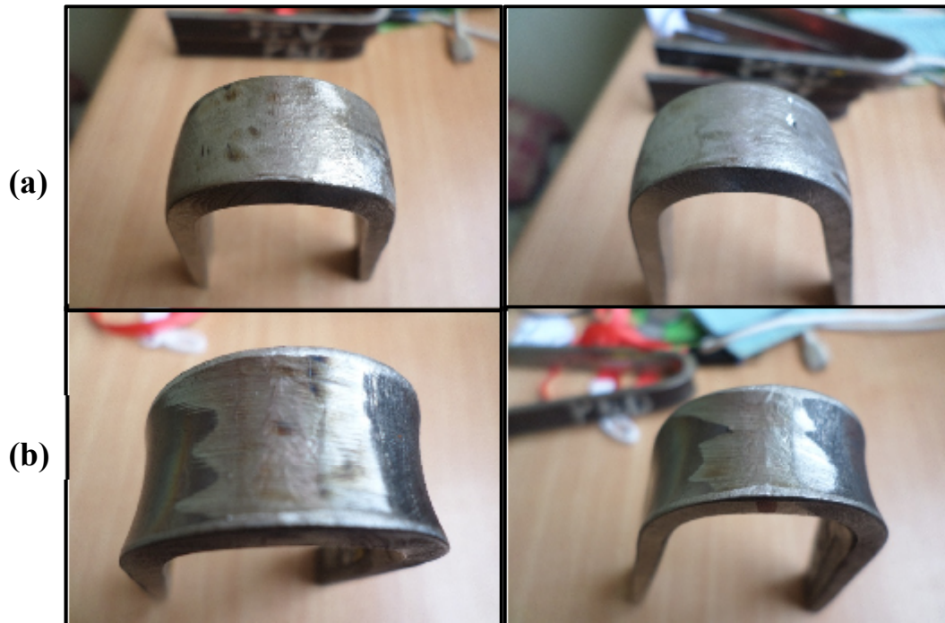
Figure V-20: Résultats de l'essai de pliage : (a) échantillons droits, (b) échantillons envers.
