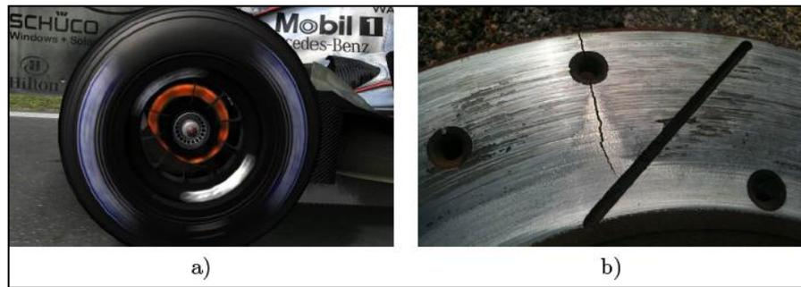
**Figure I.3** a) Dissipation thermique due au frottement dans un disque de formule 1 b) Disque de frein usé par frottement.
