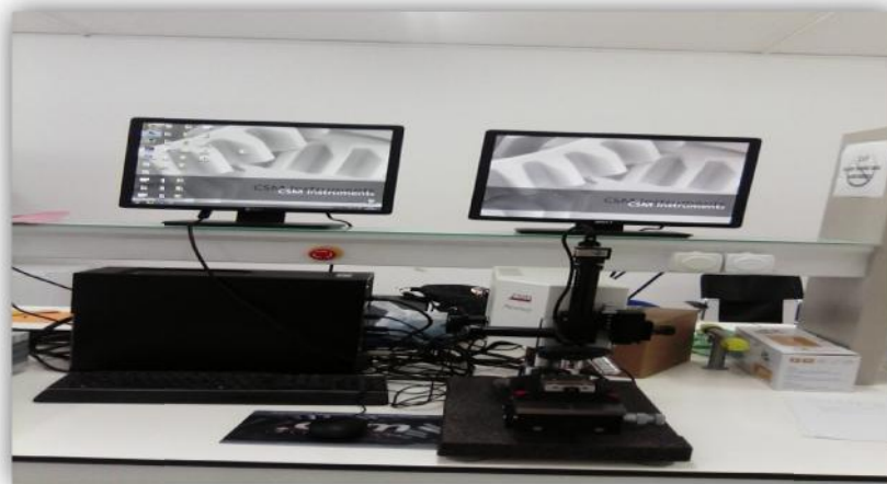
Fig. II.6. Vue d'appareil de scratch-test.
