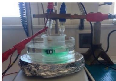
**Figure II-2** : procédé d'électrodéposition de NiO sur ITO.
