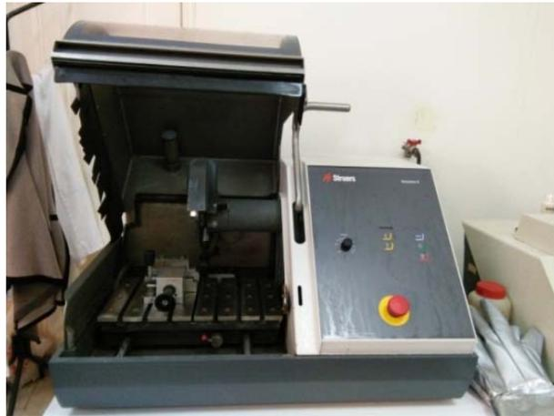
**Figure II.5:** Tronçonneuse des échantillons.
