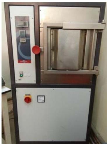
**Figure II.3 :** Four de traitement thermique.
